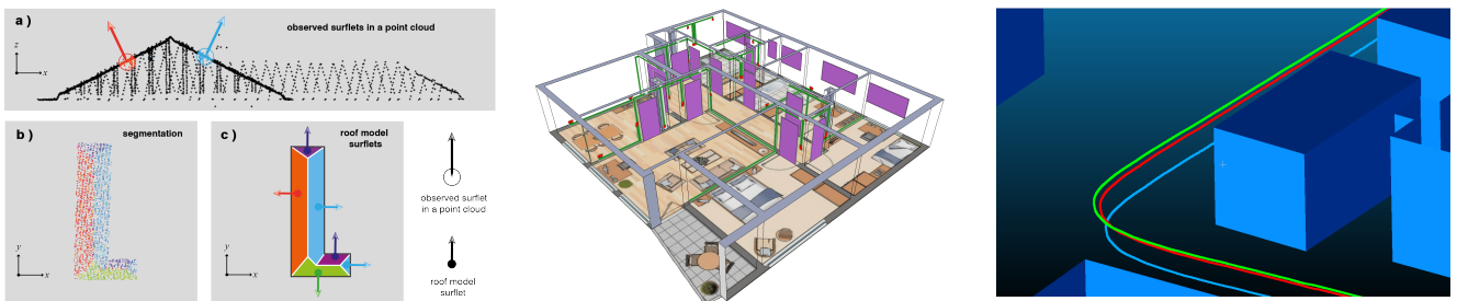
Figure 1: Drei Anwendungsbeispiele für KI in Geoinformation, Links: Klassifikation und Rekonstruktion von Dachmodellen aus 3D-Punktwolken. Mitte: Reasoning zur automatischen Abschätzung und Detektion von nicht sichtbaren Elektroleitungen in der Wand. Rechts: Verbesserung von Fahrzeugtrajektorien mit Hilfe von 3D-Stadtmodellen.
